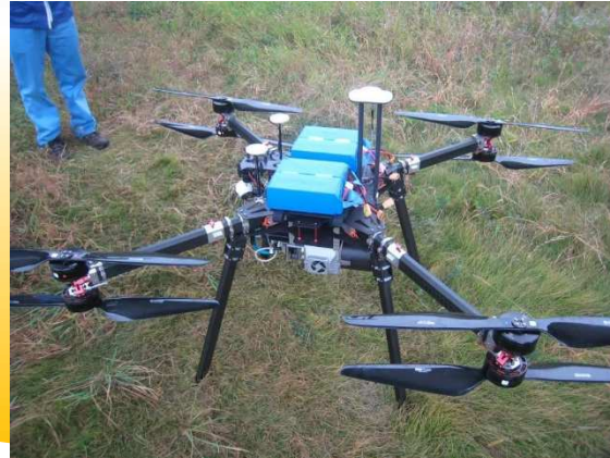
UAVレーザ測量による地形測量
