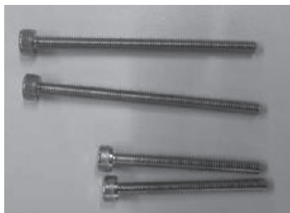
材質：40mm SCM435ステンレス (40L) 60mm SUS304ステンレス (60L)
