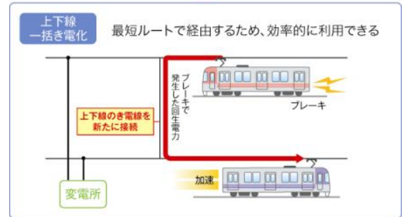
上下線一括き電化の仕組み
