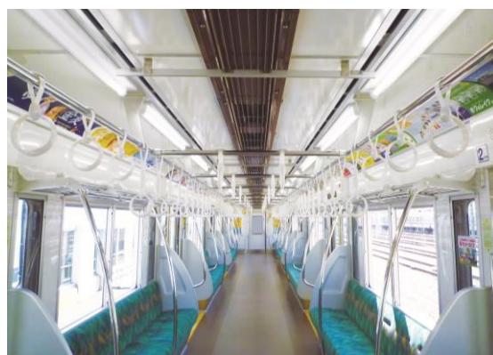
《LED照明を導入した車両室内》
