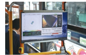
教習生席でのドライブレコーダー、デジタルタコグラフ画面
