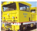
モーターカー「105D」 ダンプトロリなどを牽引し、レールや砕石を運搬します。
