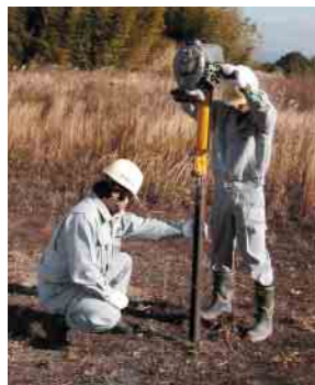
▲SCSC式簡易ボーリングによる 土壌試料採取
