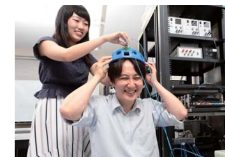
◀山口先生がかぶっている青いヘッドギアはマイクロ波で脳を可視化するCT装置を目指して開発しているもの
