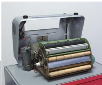
リコピー 101は、理研光学工業(現リコー)が1955(昭和30)年に発売した、わが国初の露光・現像一体の卓上型ジアゾ湿式複写機である。同時期に開発されたジアゾ感光紙により、現像後の水洗いが不要となり、無水・無臭の露光・現像を実現した画期的事務用機械であった。
