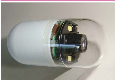
図1 カプセル型の内視鏡
