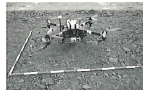
レーザスキャナを搭載した UAV
