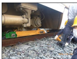
[搬送仮台車設置訓練]
