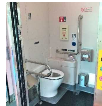
車いす対応大型洋式トイレ (写真:E131系房総・鹿島)
