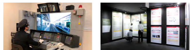
実映像を用いた臨場感ある乗務員訓練用シミュレータ
