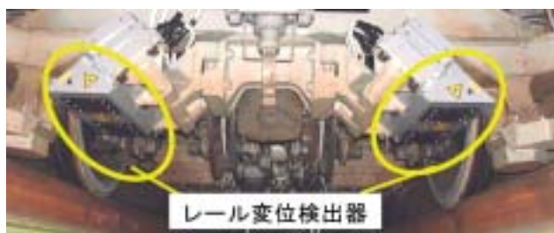
図8：光学式レール変位検出器
