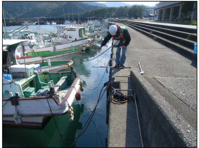
写真 15 津波の痕跡（目撃証言による最高潮位の位置を測定、図 20 の 75）
