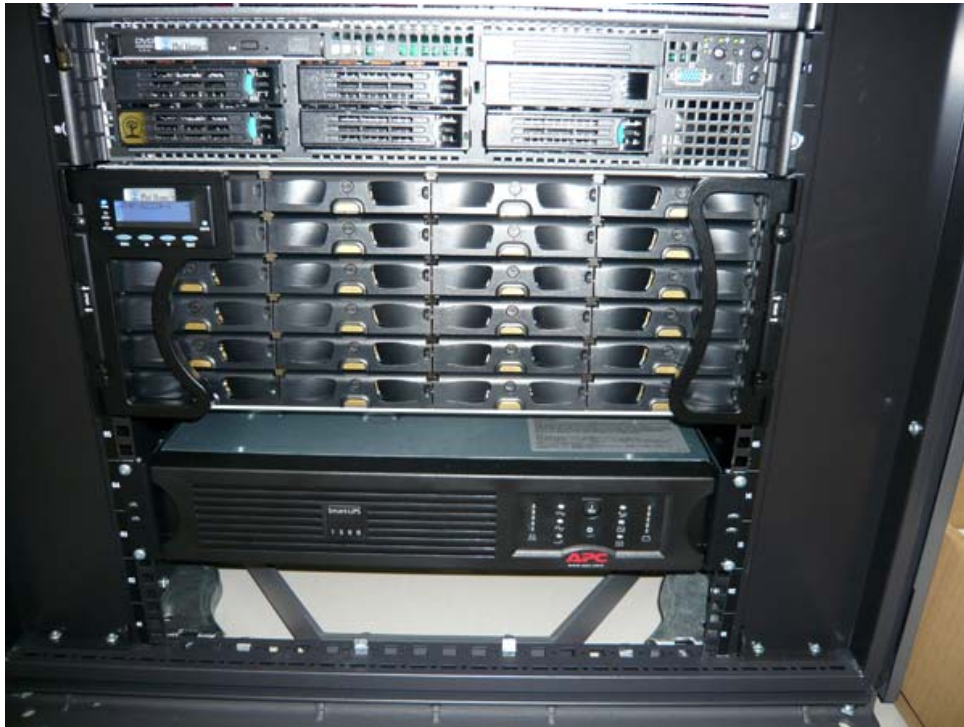
写真7 新規整備した海底地震計データの1次処理装置。上から、中央処理装置、大容量ディスクアレイシステム、バックアップ電源
