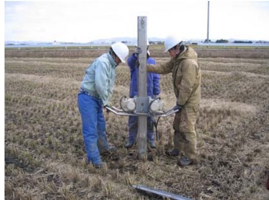
石巻平野で行われたハンディジオスライサーによる掘削調査風景
