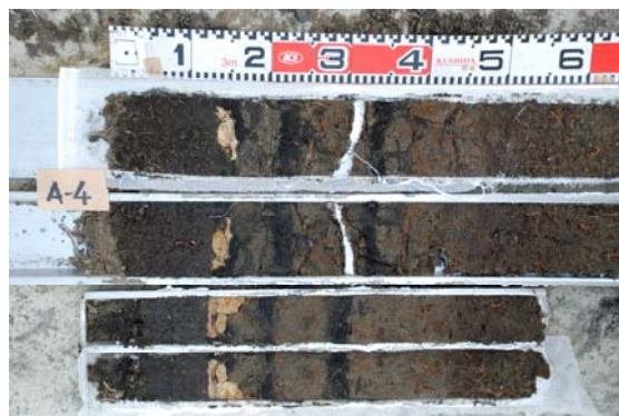
石巻平野で採取された十和田 a テフラと貞観津波を含む 3 層のイベント砂層 (A-4)
