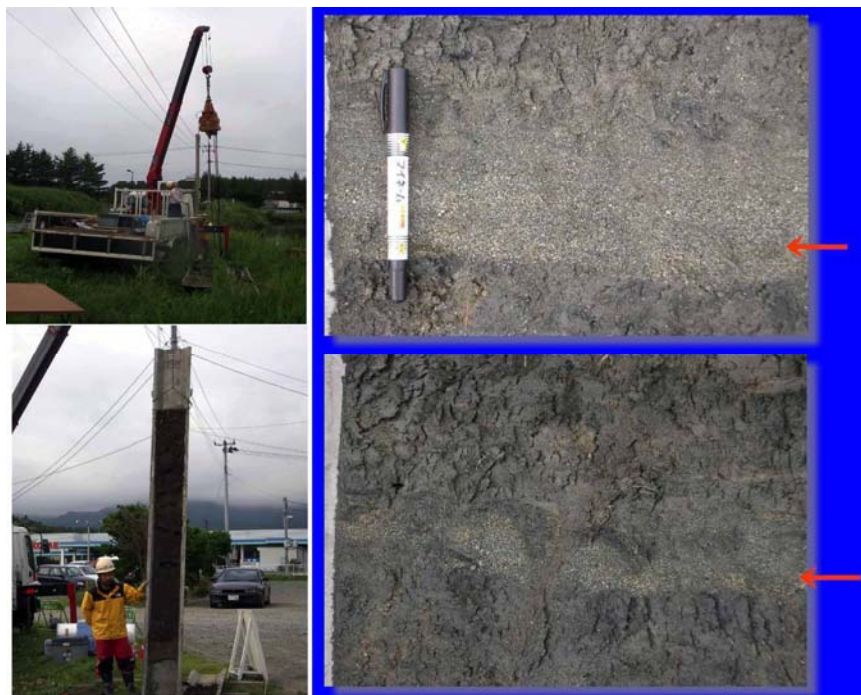
陸前高田・古川沼でのジオスライサー調査. 1960年チリ地震の津波堆積物 (右上) と過去のイベント堆積物 (右下)
