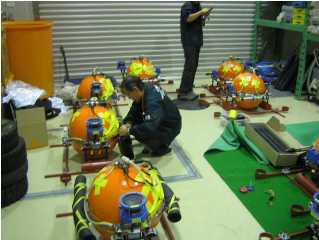
写真5 地震研究所海底観測実験室において組み立てが完了した長期観測型海底地震計6台
