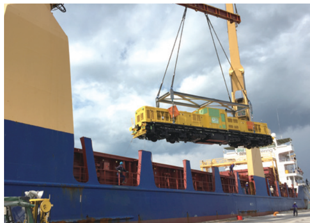
クレーンで吊り上げて、輸送船に積み込む (写真提供：北陸重機工業株式会社)
