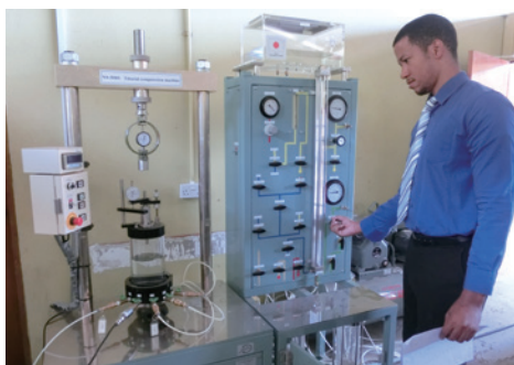
グレナダ向けに調達した、土の強度を測定する高圧三軸圧縮試験機
