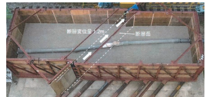
土砂箱を用いた断層模擬実験
