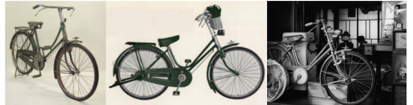
写真1(左) 昭和26年の大利根号。重さ23kg、地面からループ部までの高さ50cm、ハンドル装着部の長さ23cm、サドル装着部の長さ52cm。当時の女性の体形と体力を考えると特に30代以降の女性には乗りにくかった。前カゴは付いていない(自転車文化センター所蔵) 写真2(中) ママチャリの元祖といえる昭和31年のスマートレディ。重さ21kg、地面からループ部までの高さ41cm、ハンドル装着部の長さ12cm、サドル装着部の長さ42cm。大利根号と同じ26インチであるが重心が低く、足を高く上げなくても乗ることができる他、前カゴが付いている。定価13,500円は当時の自転車の価格としては廉価で、しかも12回の月賦販売であった(山口自転車カタログより) 写真3(右) 昭和35年頃の花嫁道具として洗濯機、ミシンと共にスマートレディが入っている(自転車文化センター所蔵)
