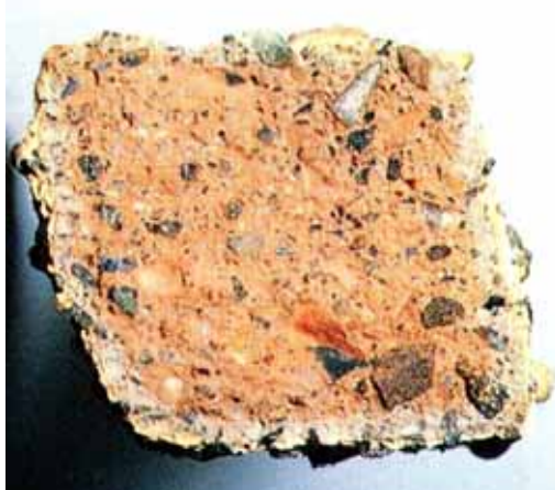
写真 2 硫黄侵入深さ試験結果（ニトロアゾ化合物による呈色状況） 8)
