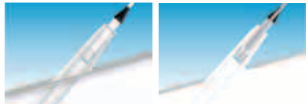
図4.12 主桁上面にケーブルを定着
