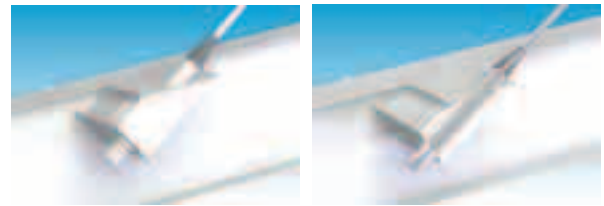
図4.11 桁外側にケーブルを定着
