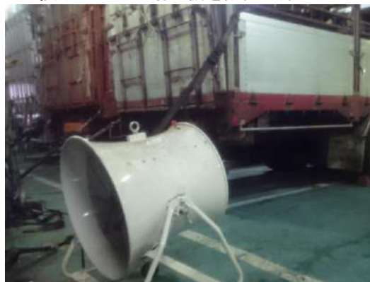
事例2：換気のための扇風機を設置（船内）
