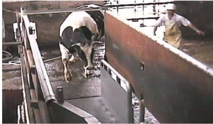
(追込み施設は牛の目より高いコンクリート壁を設置する)
