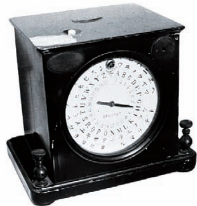
■写真3. ブルケット文字指差電信装置
