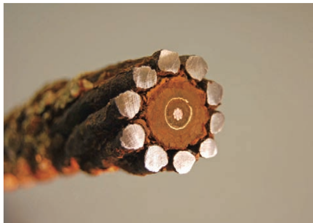
■写真4. 長崎県小ヶ倉に陸揚げされた最初の国際海底ケーブルの断面図
