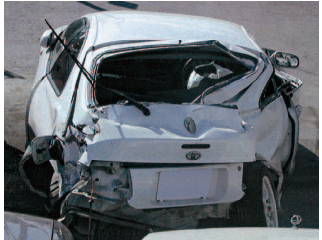
車両の状況（右側面後部衝突、大破）
