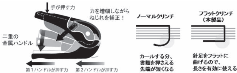
図5 パワーアシスト機構を組み込んだ「フラットかるヒット」
