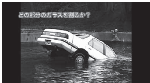
画像3 エンジンの重みで前傾する水没車。後部ガラスを割って脱出
