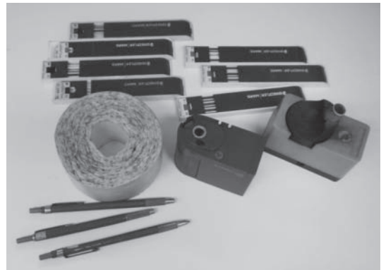
図2 ホルダーとさまざまな濃さの替え芯。 芯削りと芯の削り粉落とし（トイレトペーパーにテープ巻をして補強し輪切りにしたもの）
