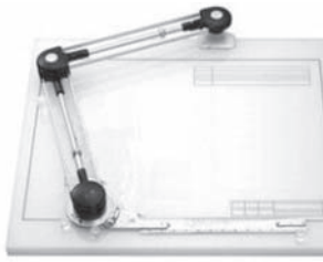
図1 ドラフターと呼ばれる製図機器 平行定規にL字の部分が付いたものもあった
