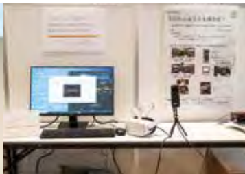
↑MRによって発達障害の状態を疑似体験できる宮崎英一氏のシステム。
