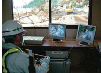
遠隔操縦式バックホウの操作
