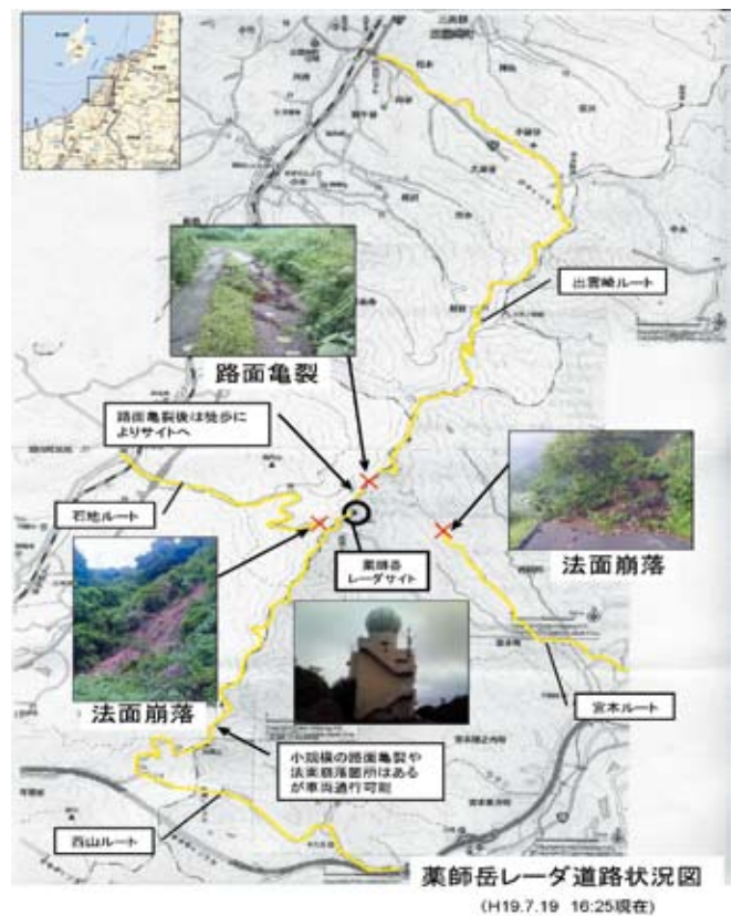
図2-5-1 薬師岳レーダ雨雪量計 道路状況
