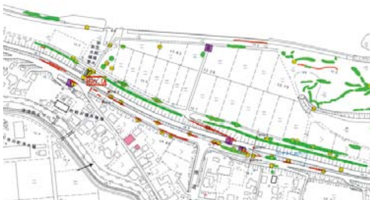
図2-1-3 信濃川液状化痕跡被害状況図 (長岡市寺泊町軽井地先)
