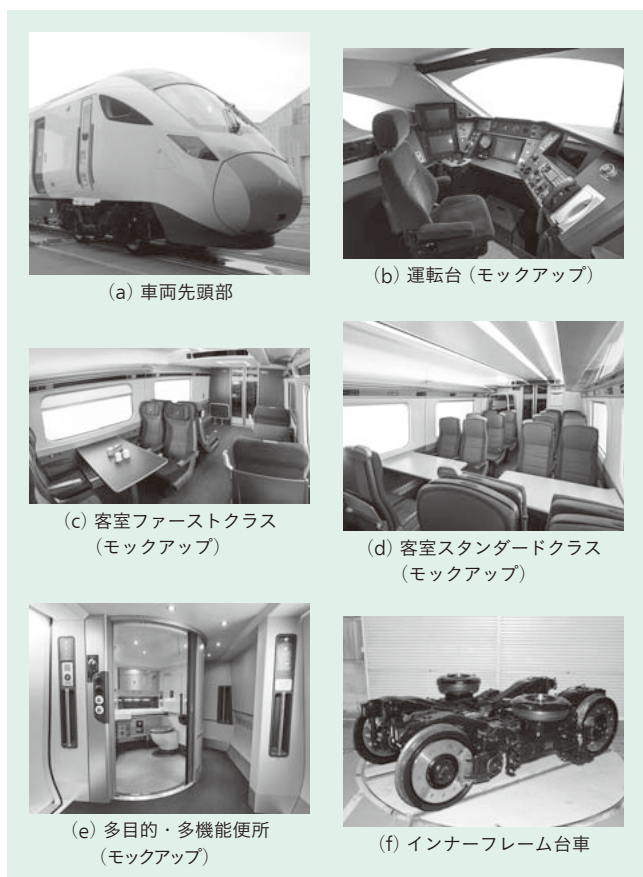
図3 | 車両先頭部、運転台、客室、多目的・多機能便所、台車の外観 先頭形状は高速車両にふさわしい「One Motion Form」とし(a)、運転台は操作性や視認性について運転士およびヒューマンファクターの専門家による評価を受け設計に反映している(b)。客室や便所は実物大のモックアップを製作し、ステークホルダーの審査を受けて仕様を確認するとともに改善点を抽出して設計に反映している(c)、(d)、(e)。9両編成中間車の従台車の台車枠をインナーフレーム化することで大幅な軽量化を実現している(f)。
