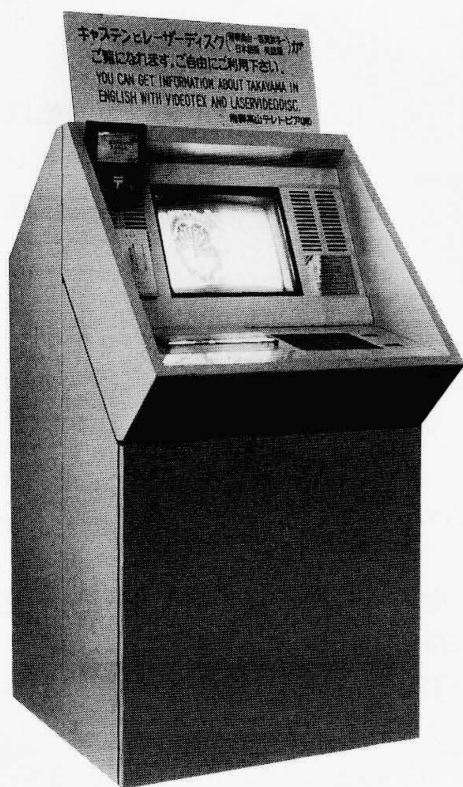
図11 レーザディスク内蔵キャプテン端末の外観 一般街頭形キャプテン端末とイメージを合わせた外観となっている。
