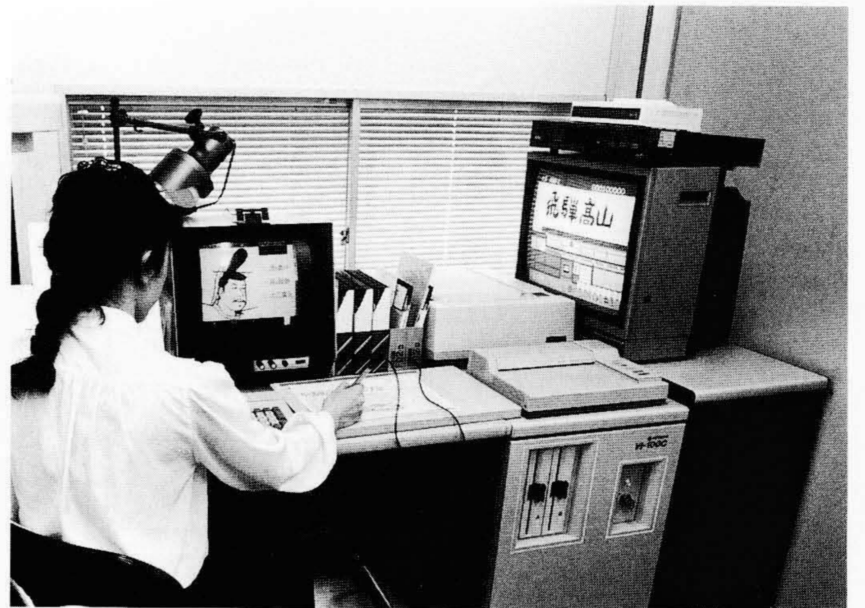
図7 キャプテン用文字図形入力装置VI-100Cの外観 カメラ入力、スキャナ入力とも可能で操作しやすい構造となっている。
