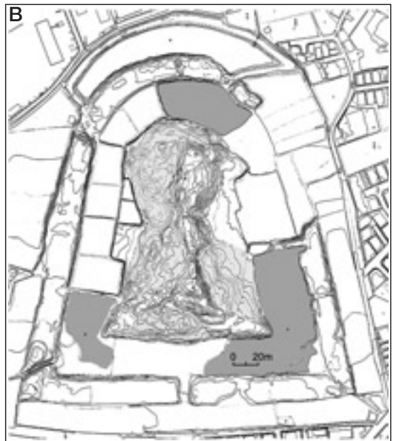
第3図 有馬-高槻構造線活断層系上に位置する今城塚古墳(A)と現在の状況(B)。伏見地震により地すべりを起こして、古墳の至る箇所が崩れている。
