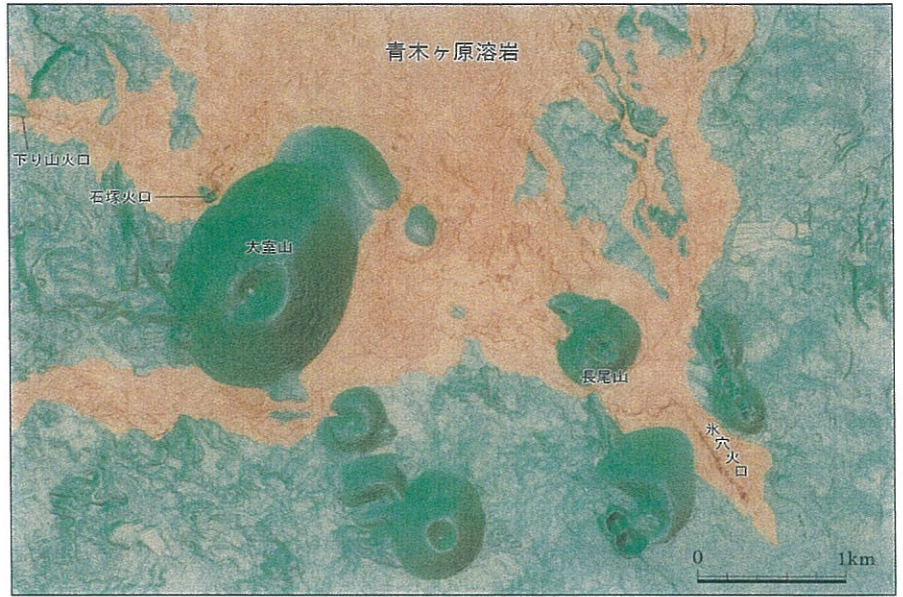
図 11 青木ヶ原大室山付近のレーザスキャナ測量による陰影画像
