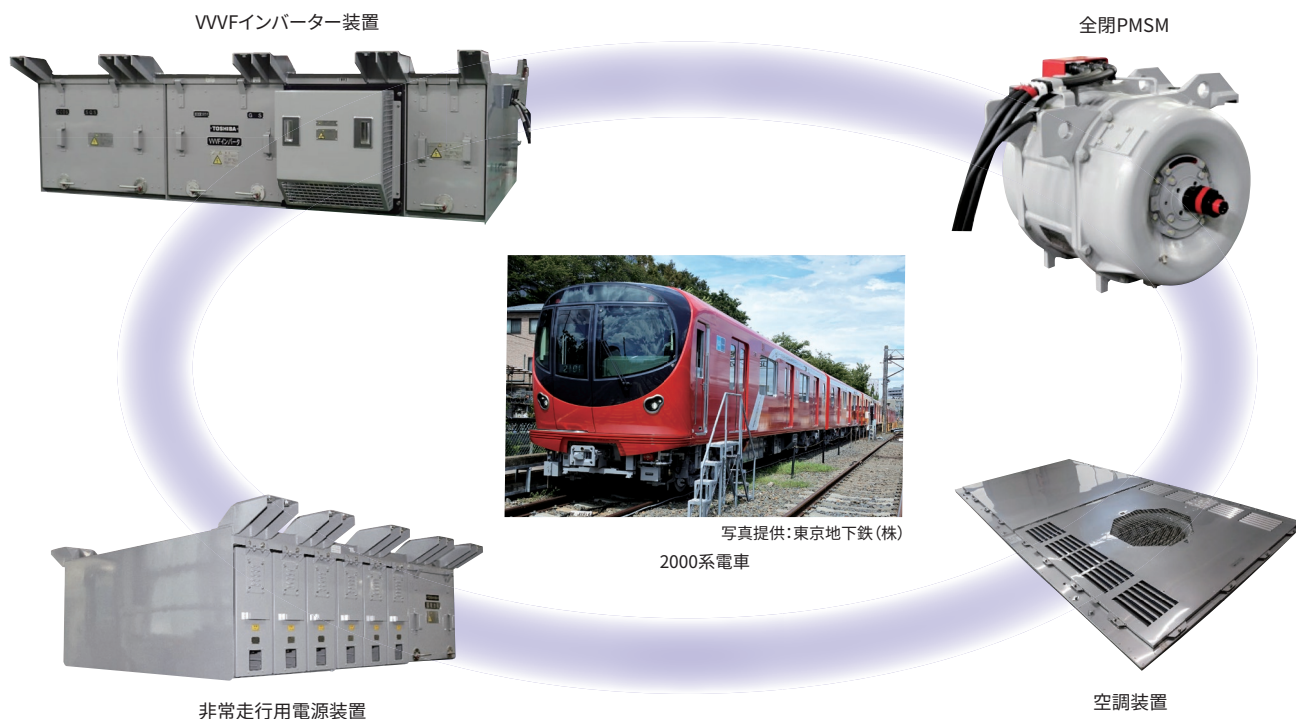
東京地下鉄(株) 2000系 新型車両の電気品
