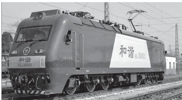
図4. 海外用電気機関車 — 電気機関車の制御システムとしてTCMSを搭載し、複数の機関車の重連運転を実現している。
