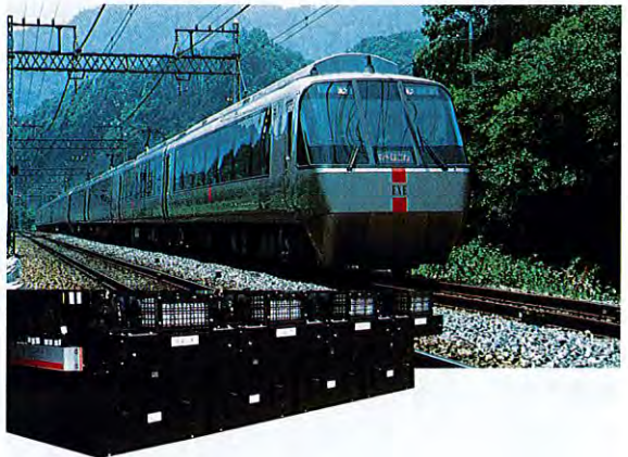
30000 形新型特急ロマンスカー EXE と IGBT 個別制御 VVVF インバータ装置 Series 30000 EXE express train, and IGBT individual-axle-control type VVVF inverter
