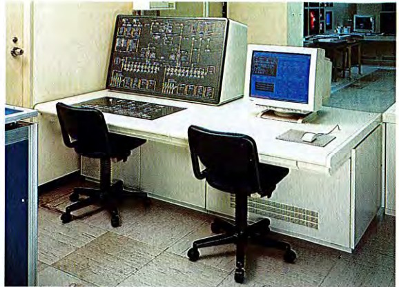
新シリーズのヒューマンインタフェースステーション Human interface station of BUILDAC TM -GF new series
