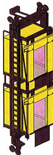
ダブルデッキエレベーターかご・巻上機 Cage and machine for double-deck elevator
