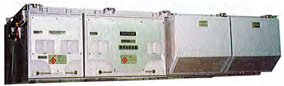
デュアルモード VVVF/CVCF システム Dual mode individual-axle-control type VVVF/CVCF system
