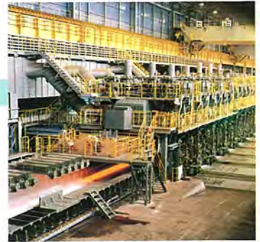
(a) 熱間圧延設備
