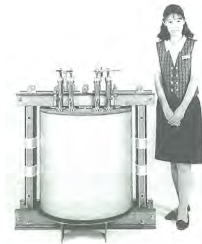
超電導変圧器
