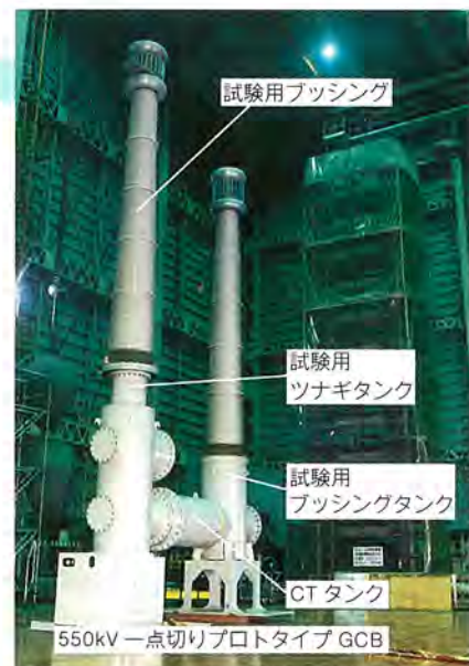
耐電圧試験に供試中の550kV一点切りプロトタイプGCB
