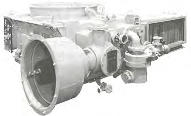
500系電車で用主変圧器
