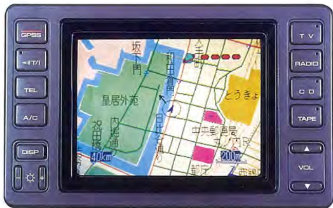
ユーノス・コスモ搭載の車載情報システムにおけるナビゲーション画面例
