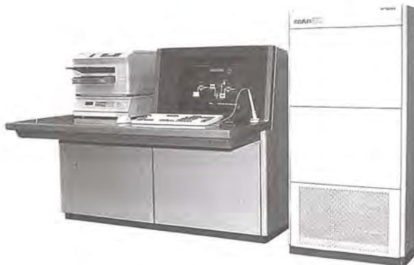
水道施設遠方監視制御システム“W30”
