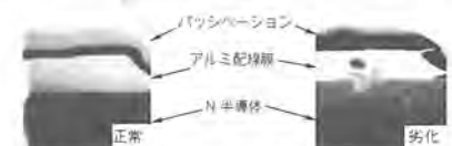
サージに起因するアルミ配線膜内のパルスやN 半導体への影響などが観察される。
