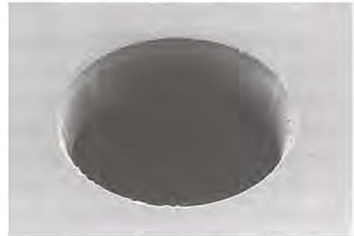
ポリイミド絶縁層の穴開け加工例(穴径：70μm、厚さ：15μm)
