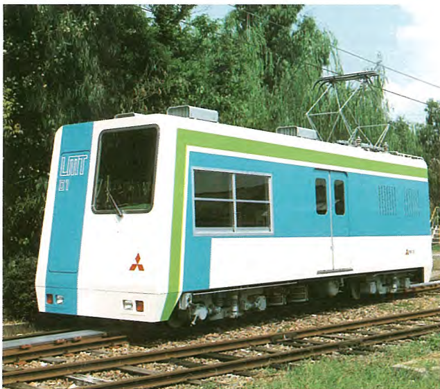
リニアモータ電車総合試験設備(試験電車)
