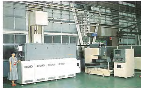
SD式5kW CO 2 レーザー発振器ML50C (左：発振器3, 950mm(W)×950mm(D)×2, 175mm(H), 右：加工機)
