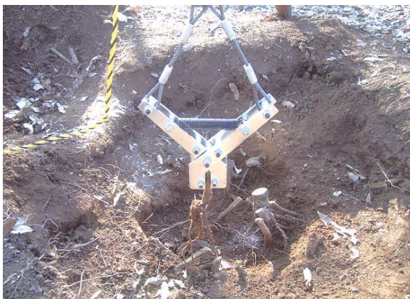
写真1 根の引き抜き強度測定試験
