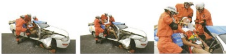
スーパバネムを折し、KED を装着したら、KED の持ち手（リフトハンドル）を解き3名で持ち上げ、そのまま上方へ持ち上げる。ローフが開きまわっていると上部方向へ救出が可能。
