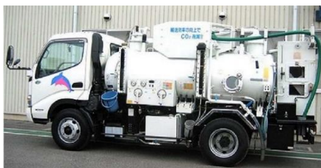
写真 1.4-13 汚泥濃縮車の例 9)
