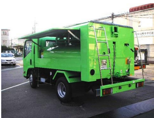
写真 1.4-11 エコパネル式バキューム車の例 5)
