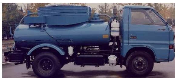
写真 1.4-7 ホースリール搭載バキューム車の例 5)
