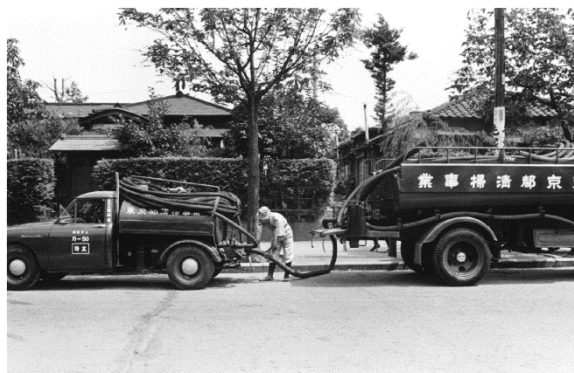
写真 1.4-14 親子作業方式によるし尿の積み替えの例 1)
