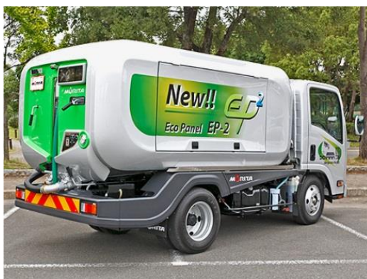
写真 1.4-12 改良型エコパネル式バキューム車の例 5)
