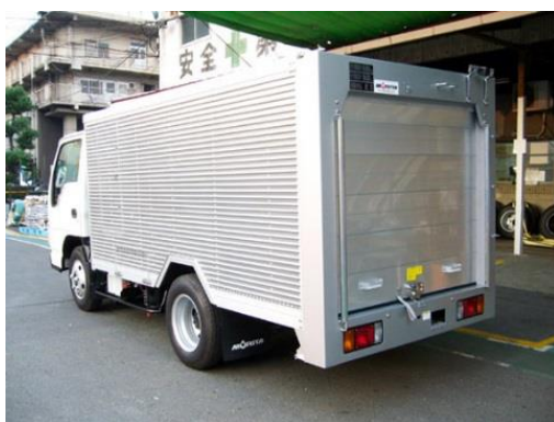
写真 1.4-10 アルミパネル式バキューム車の例 5)
