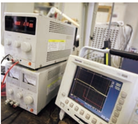
電圧・電流自動計測装置
