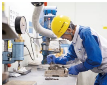
特混研究部では日々試作・改良が進められている。写真は、モルタルの強度や固まり方などを測定する実験。
