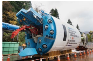
新たに開発された「NATBM掘削機」。不良地山でのNATMモードでは、前部の赤い「バケット式掘削機」を使用し、安定掘進する。
