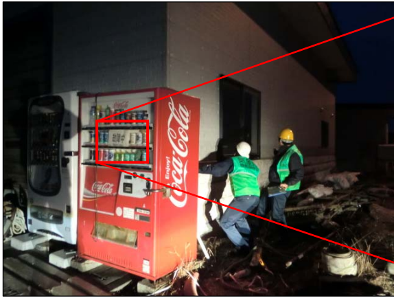
写真 5-8 津波の痕跡（長万部町国縫漁港、表 1 の 18）
