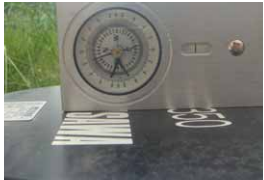
震度計は南方向が上位になって、約 2° 傾いている。
