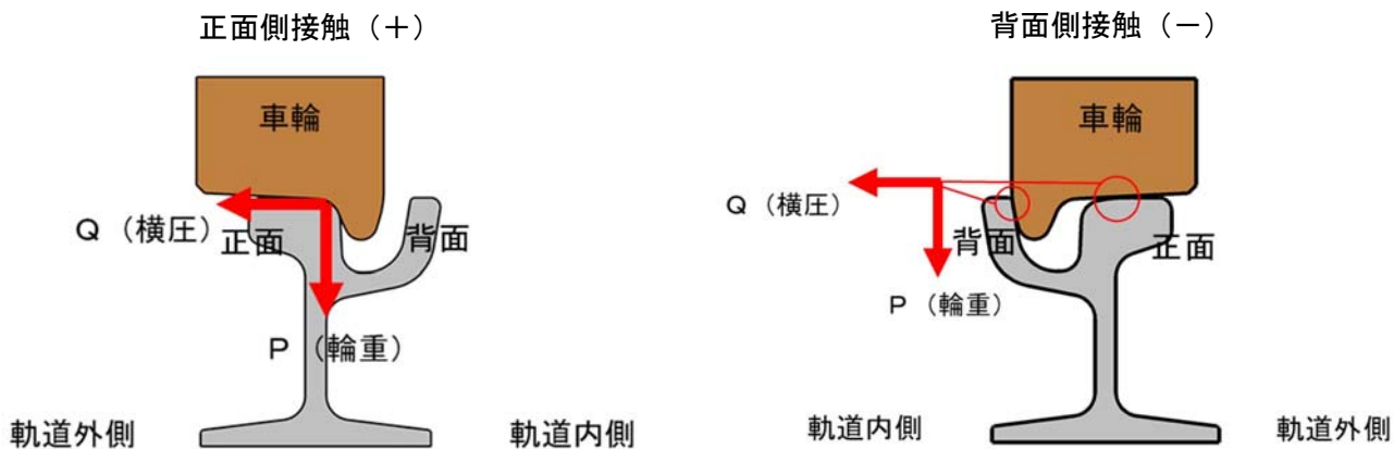
図 18 横圧と輪重のイメージ
