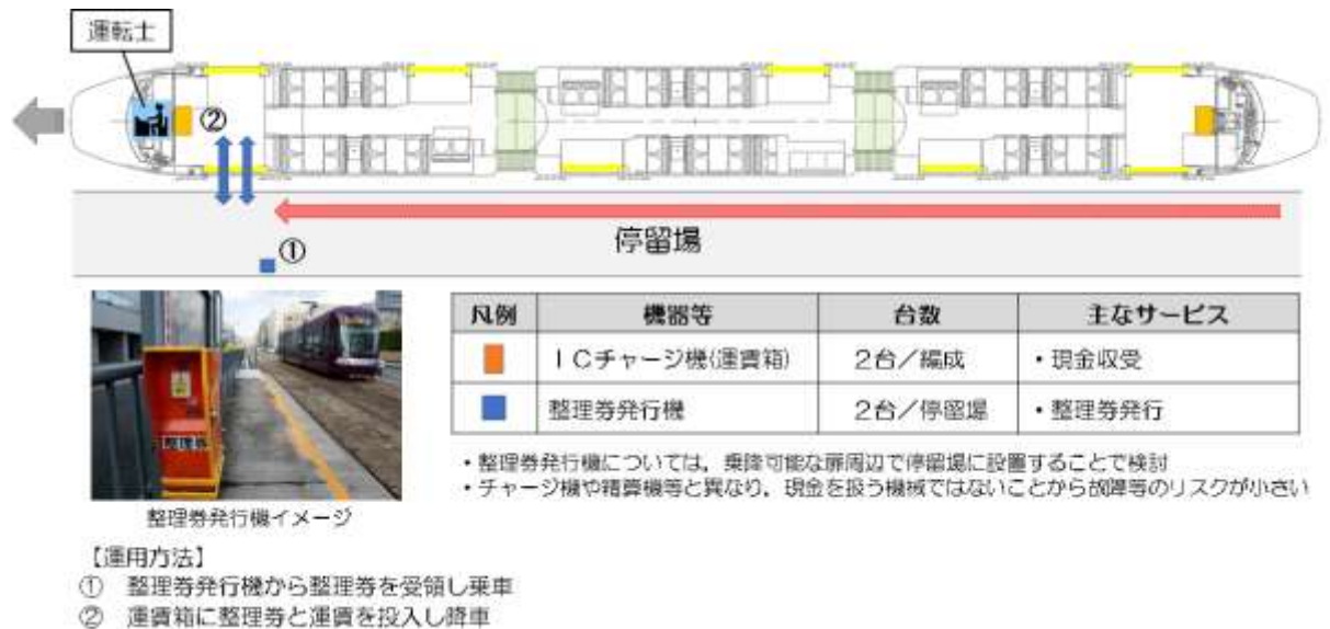
図4 先頭車両の運賃收受機器の配置イメージ
