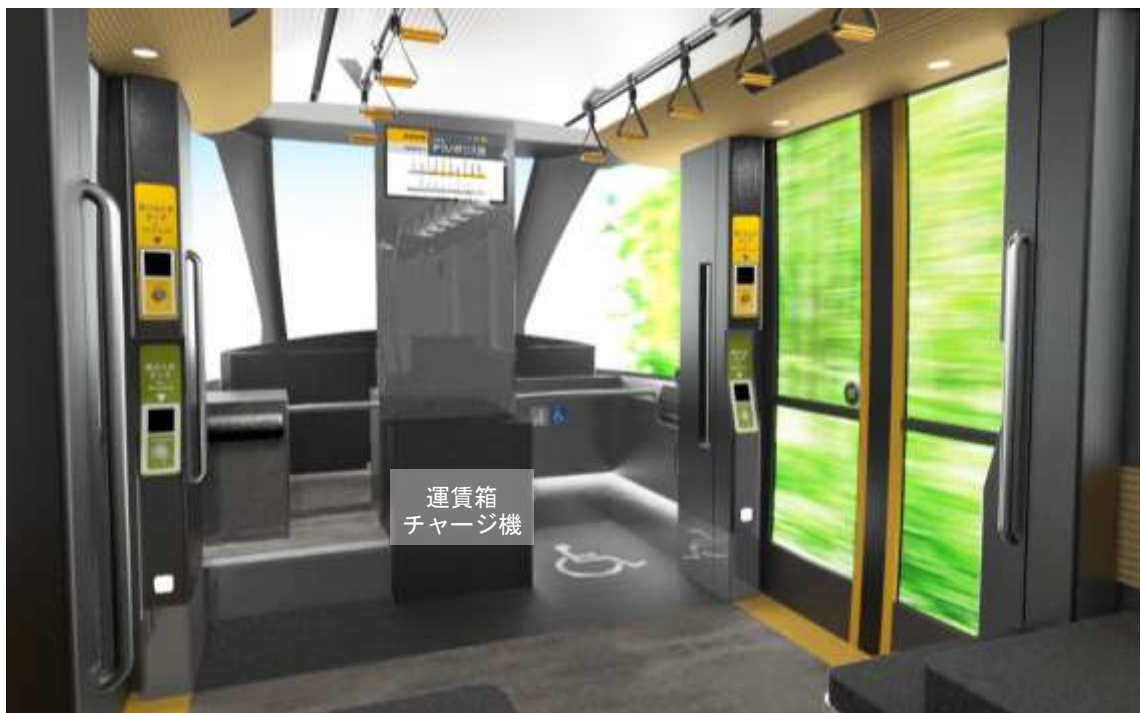
図4 先頭車両の運賃收受機器の配置イメージ
