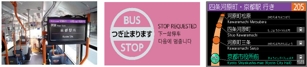
車内中央部に増設した案内モニター（日本語・英語・中国語・ハングルに対応）
