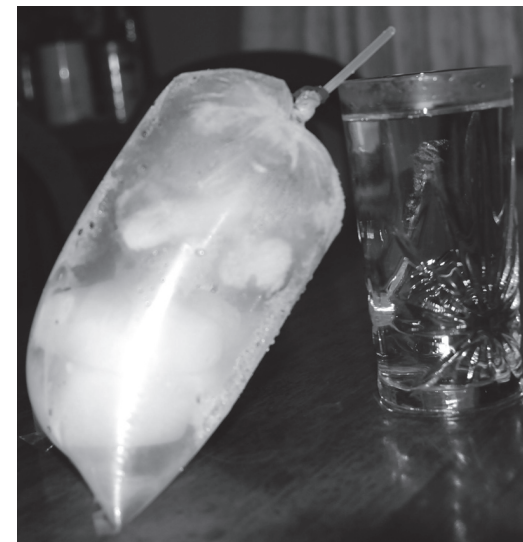
図1 昇華したCO 2 ガスを水に通す
