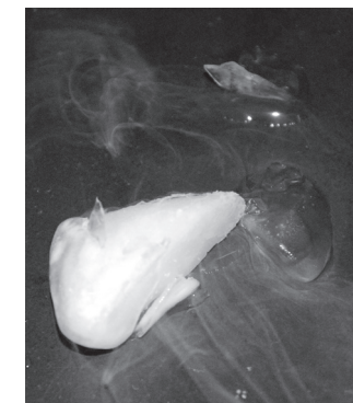
図9 ドライアイスの表面を覆った氷の皮膜
