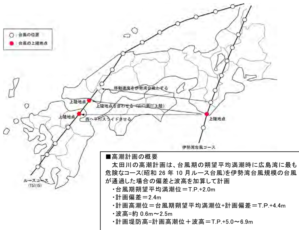
図 2.2.8 高潮計画の概要及び過去の台風の経路
