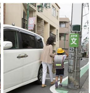
<歩行の支障となる電柱の事例>
